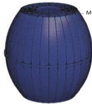
ผ่านการออกแบบความแข็งแรงของโครงสร้างถังด้วยโปรแกรม Finite Element ที่ใช้ตรวจสอบโครงสร้างของถังสูง
